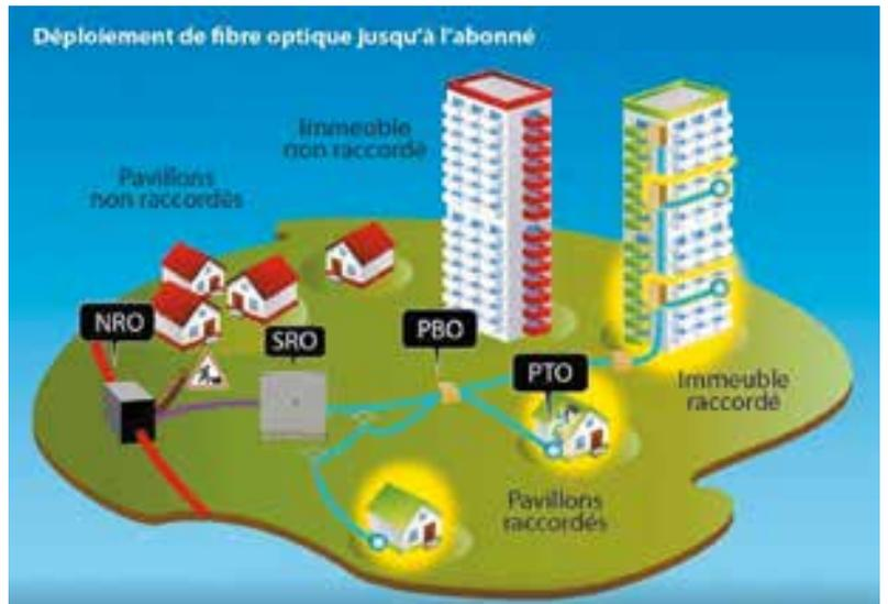
Nœud de Raccordement Optique, SRO : Sous-répartiteur optique, PBO : Point de branchement optique, PTO : Point de terminaison optique.
