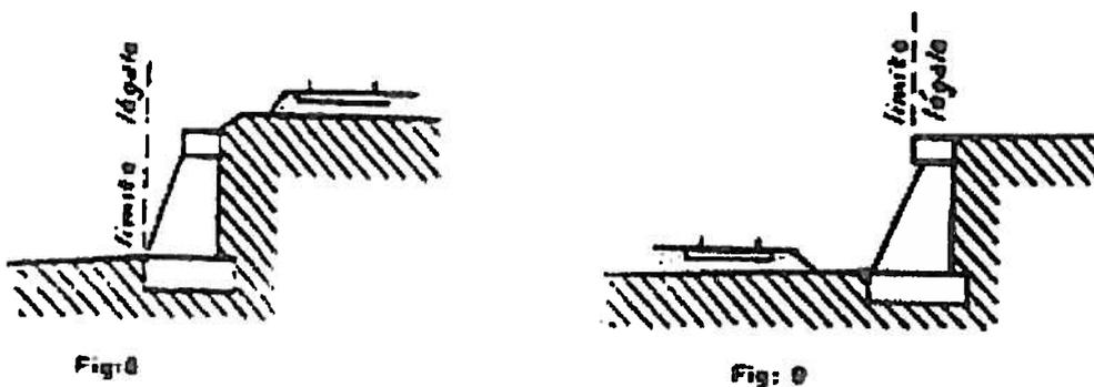
Lorsque le chemin de fer est établi en remblai et que le talus a été rechargé ou modifié par la suite d'apport de terre ou d'épuration de ballast, la limite légale pourra être déterminée à partir du pied du talus primitif, à moins toutefois que cet élargissement de plate forme ne soit destiné à l'établissement prochain de nouvelles voies.
